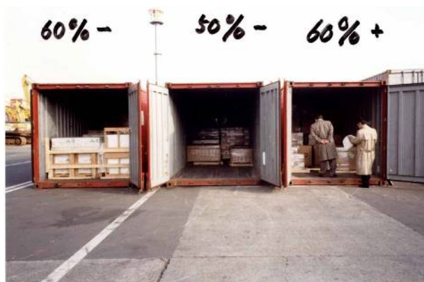
入港後、直ちにコンテナ内利用率(パッキング効率と呼ぶ)をチェックさせた。写真程度の利用率では改善(もっと詰める)命令を出すことになる。
